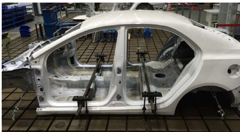
图 7 白车身在基准平台上的固定方式
