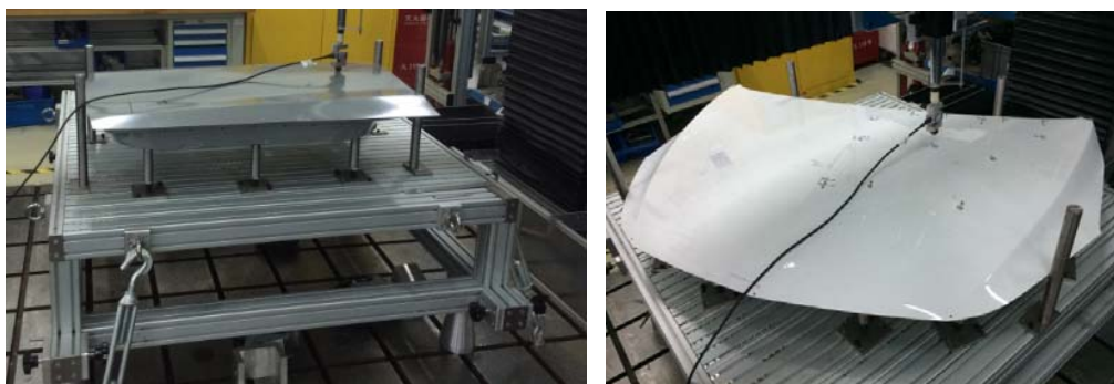
图 8 门盖类零件在基准平台上的固定方式
