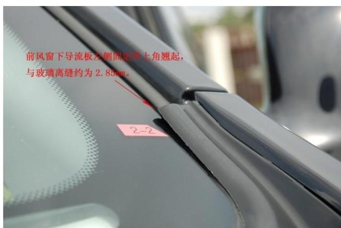
图A.8 非金属件翘曲、变形
