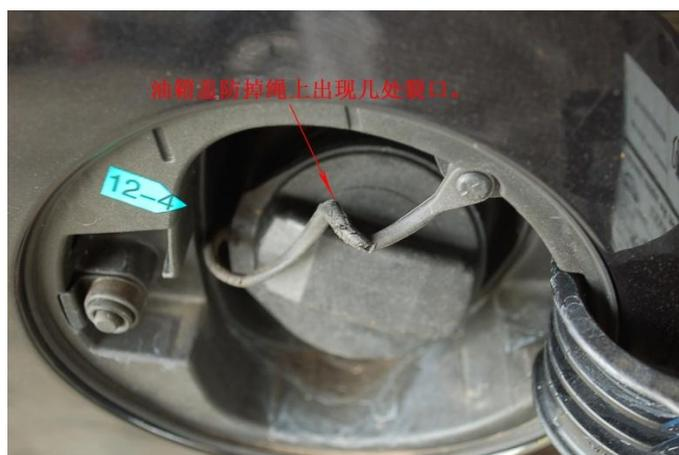
图A.6 非金属件裂纹
