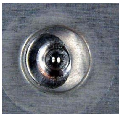
铆扣严重变形
