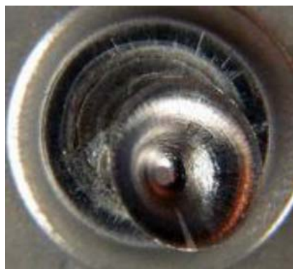
图8铆钉穿透示意图
