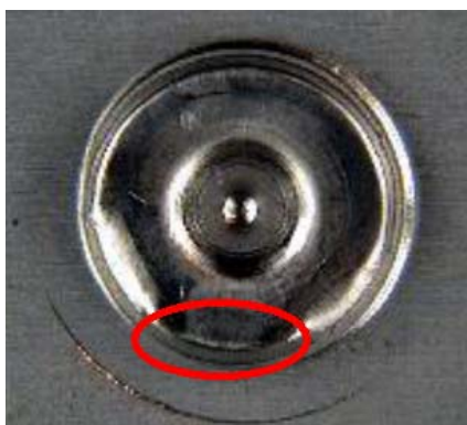
图10铆扣开裂示意图
