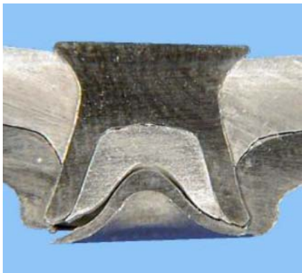
图 18 铆钉尾部穿透底层板材
