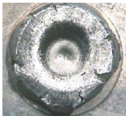
图11铆扣开裂示意图-铸件
