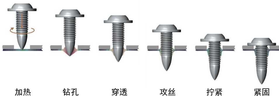
图1 流钻铆接过程
