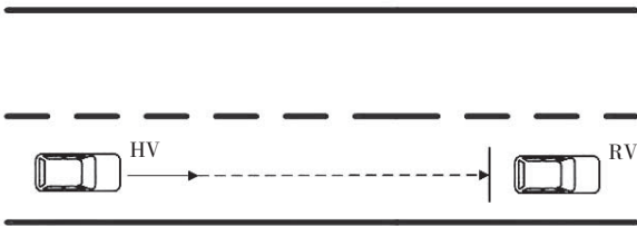
图 3 FCW: HV 行驶, RV 在同一车道前方停止
