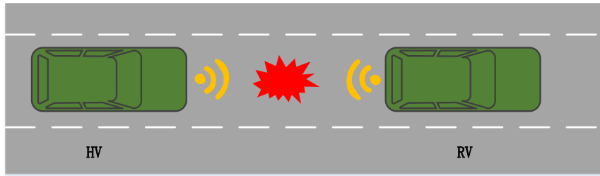
图 13 基于 V2X 的前向碰撞预警（FCW）功能测试工况示意图
