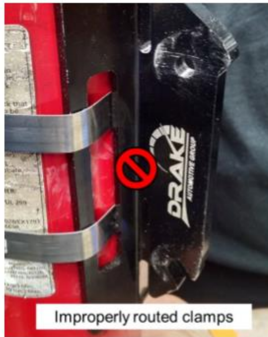
图B-47：软卡箍固定错误。
