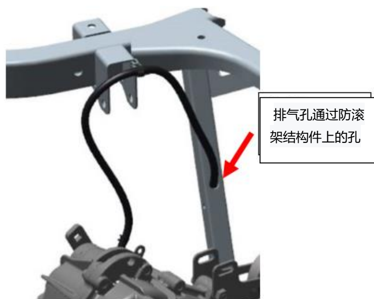
图B-51：齿轮箱排气示例，它终止在一个框架内。
