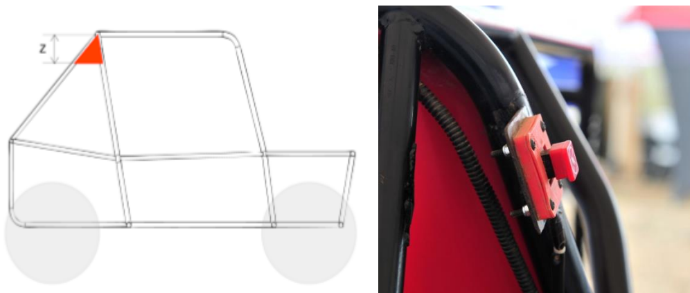
图B. 6. 2. 5. 2：开关安装位置
