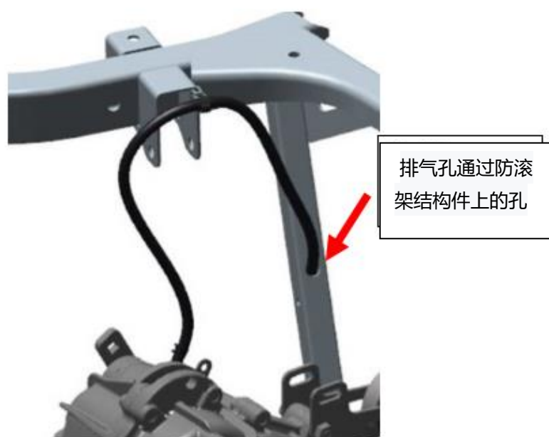
图B-51：齿轮箱排气示例，它终止在一个框架内。
