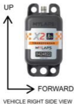
图B-62：应答器定位
