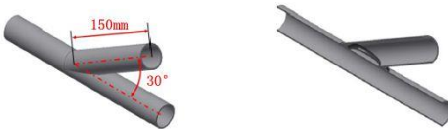
图B-22：防滚架焊接试样2
