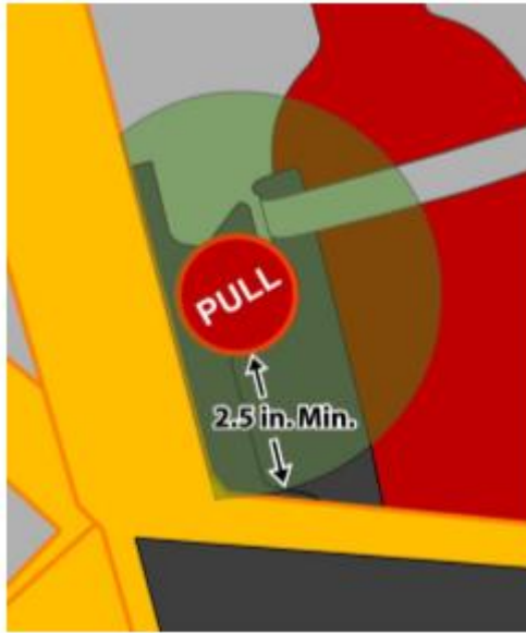
图B-48：灭火器，拉手周围间隙示意图(绿色)
