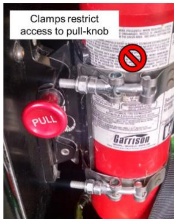
图B-46：灭火器夹头方向错误。
