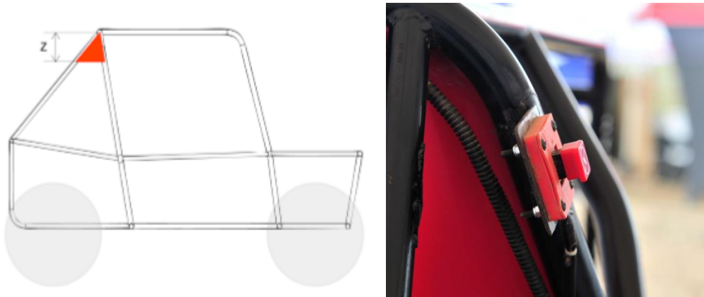
图B-54：发动机熄火开关安装位置
