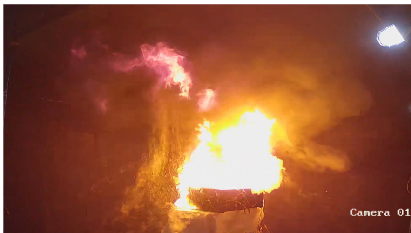
图 3-28 锂电池模组热失控实验典型照片
