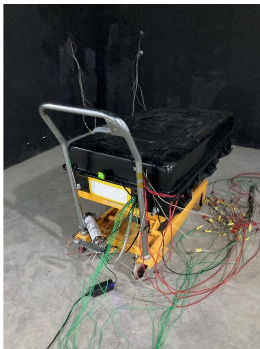
图 5-16 锂离子电池火灾防控装置效能验证试验模型
