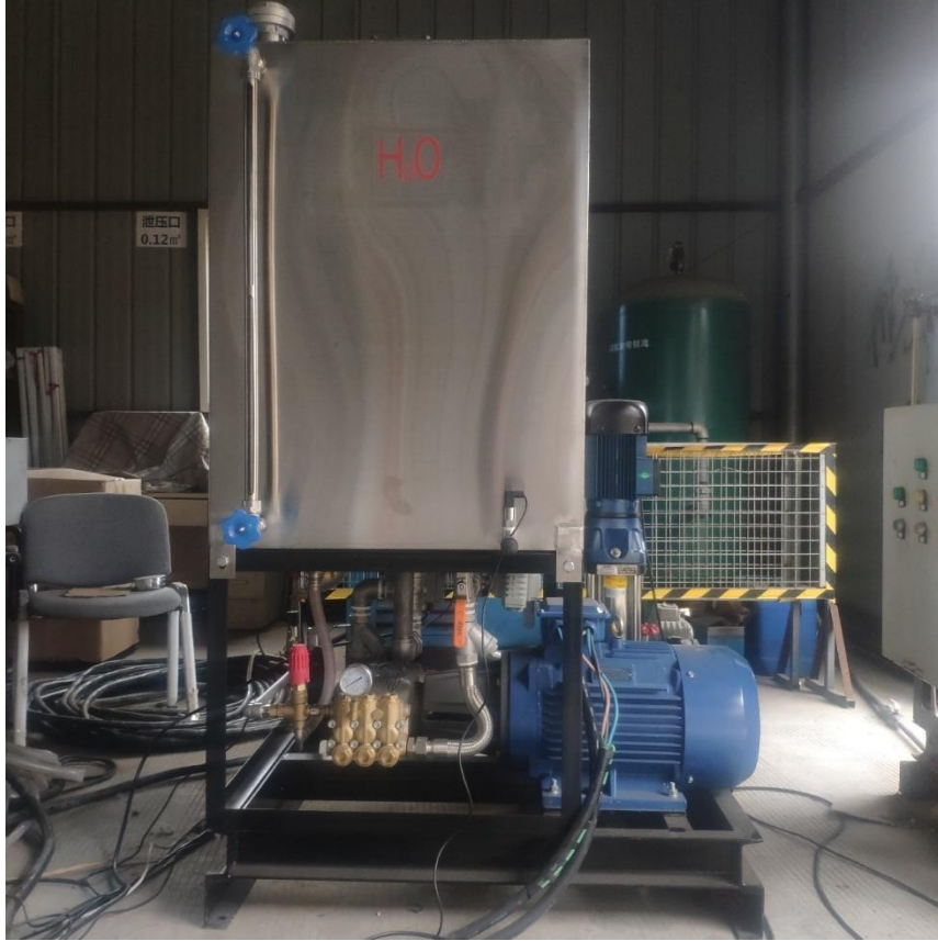
图 5-5 水灭火系统试验装置实物图
