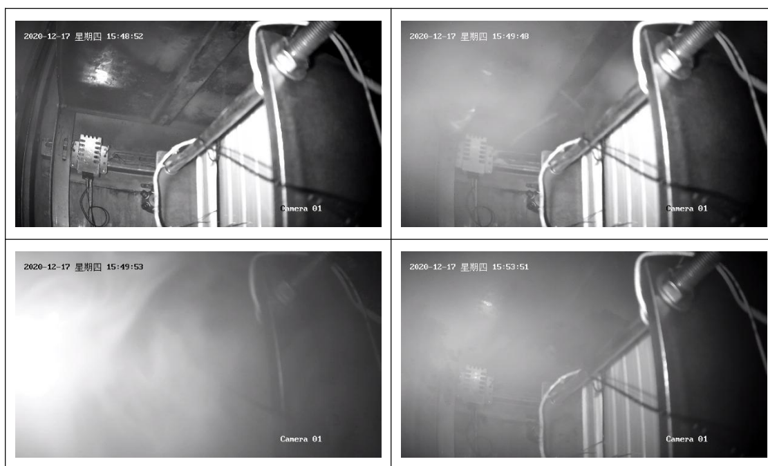
图 5-12 锂离子电池热失控灭火实验典型照片
