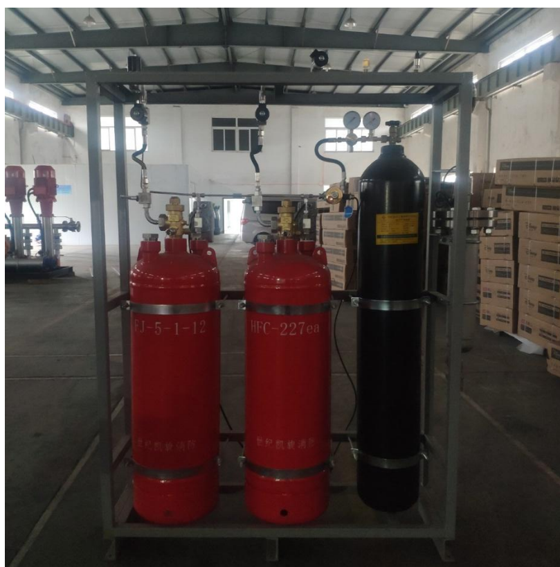
图 5-7 气体灭火系统试验装置实物图
