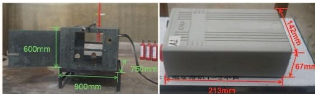
图 5-3 实验灭火单室及动力锂电池实物图
