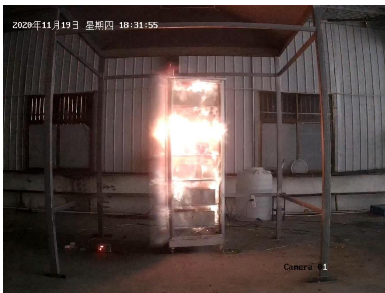
图 3-36 电柜内锂电池实验典型照片
