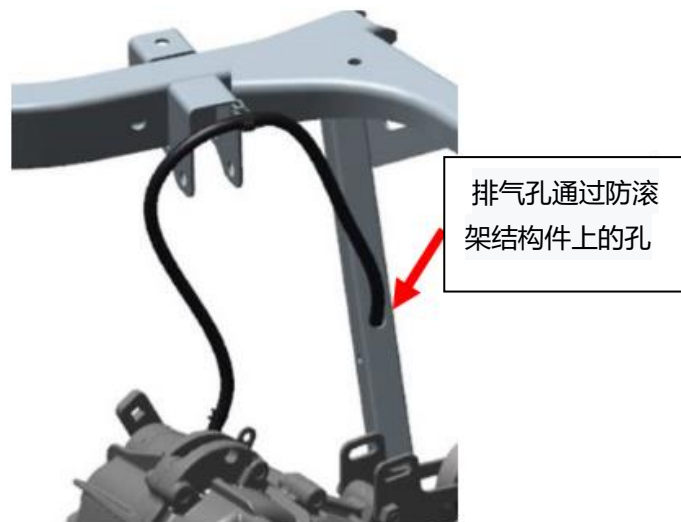
图B-53：齿轮箱排气示例，它终止在一个框架内。
