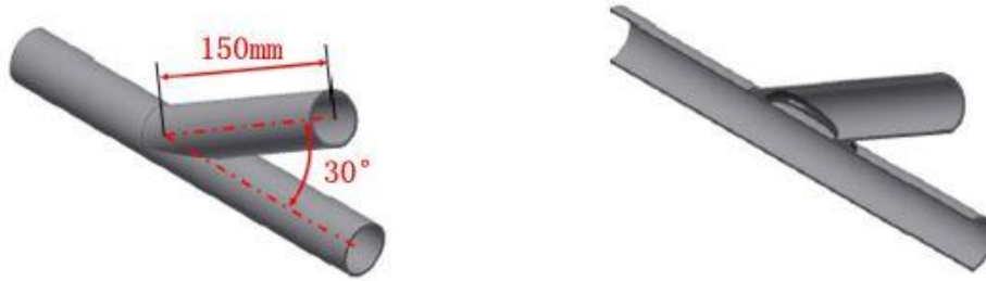
图B-29：防滚架焊接试样2
