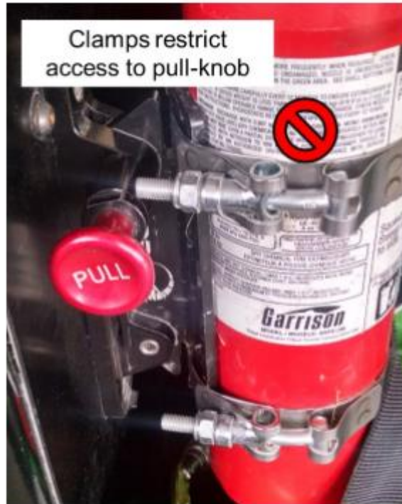
图B-48：灭火器夹头方向错误。
