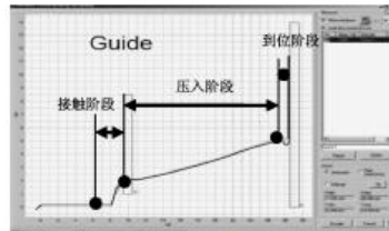
图2 导管压装曲线
