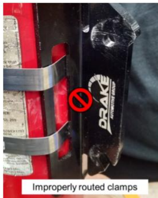
图B-56 软卡箍错误固定示意图
