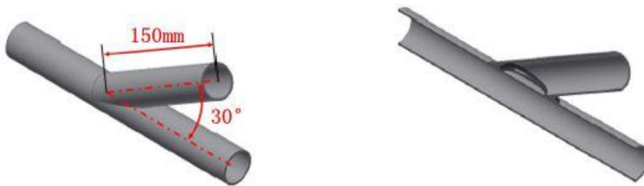
图B-34 防滚架焊接试样2
