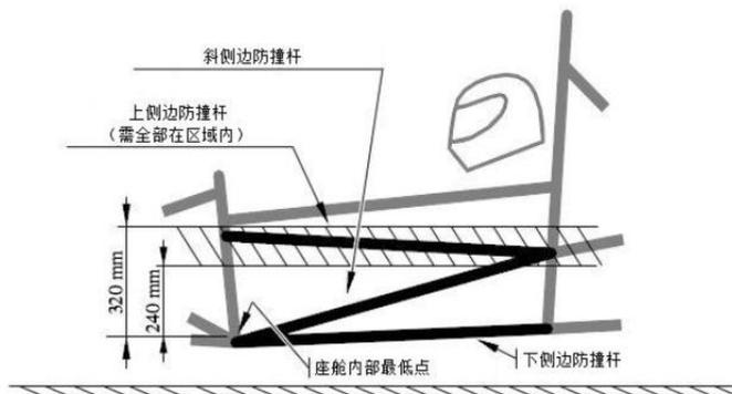
图 2.10.b 桁架式车架的侧边防撞结构
