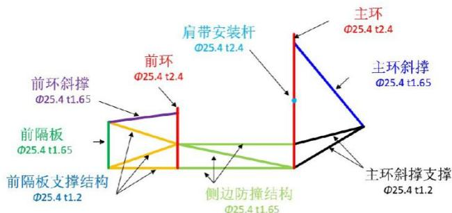
(4) 车架各部分尺寸要求示意图
