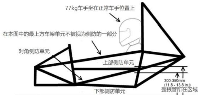
图 2.10.a 桁架式车架的侧边防撞结构
