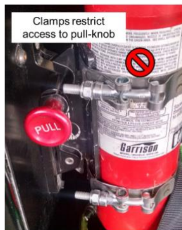
图B-56 灭火器夹头方向错误。
