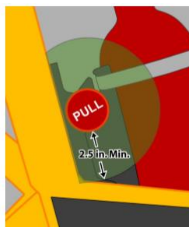
图B-58 灭火器，拉手周围间隙示意图(绿色)
