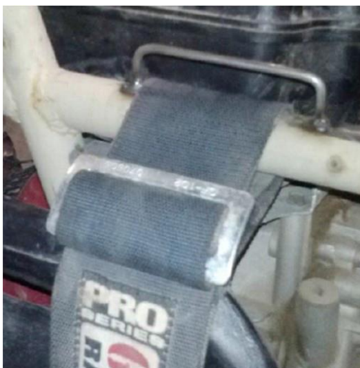
图B-44 车手肩带侧向约束
