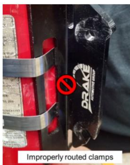
图B-57 软卡箍错误固定示意图
