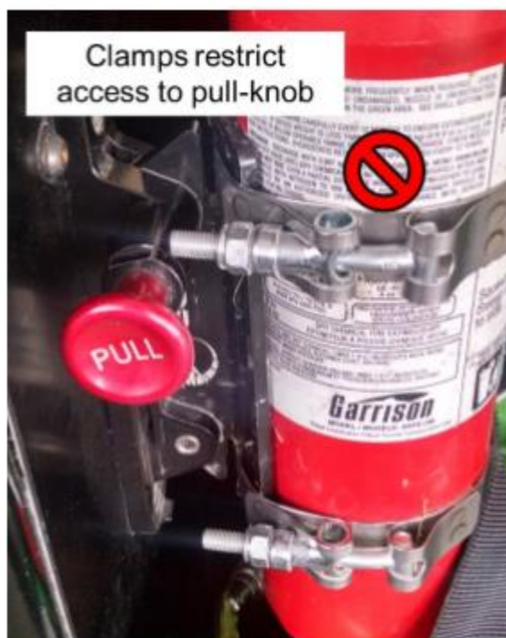
图B-56 灭火器夹头方向错误。
