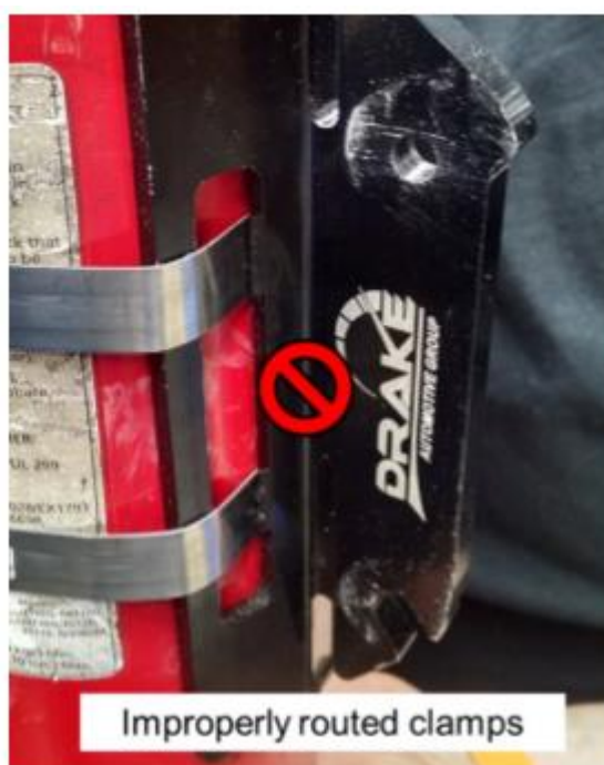
图B-57 软卡箍错误固定示意图
