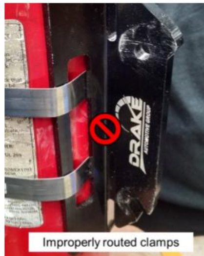
图B-58 软卡箍错误固定示意图
