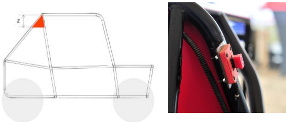
图B-66 发动机急停开关安装位置
