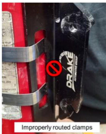
图B-58 软卡箍错误固定示意图
