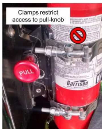
图B-57 灭火器夹头方向错误。
