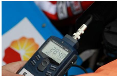
(3) 发动机噪声测试转速
