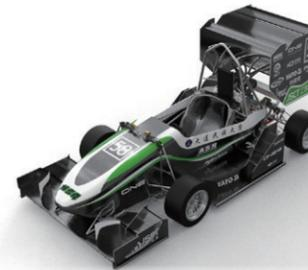
赛车车架采用钢管桁架结构，悬架系统设计均为不等长双 A 臂独立悬架，直通进气以及气动拨片换挡和可调节踏板总成；使用铃木 GSX-r600 发动机配合独立 ECU 及完备数据采集系统，提供稳定的动力输出。本车队成立于 2010 年，至今参加过 14 场比赛，现与电车队融合为一个大队，车队成员来自汉，满，回，蒙，朝，苗，瑶，彝等不同的民族，更是表现出不同于其他高校的民族赛车文化。
