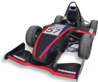
烟台汽车工程职业学院跃起车队，是一支充满激情与创新精神的大学生方程式赛车队。车队秉承精益求精，追求卓越的理念，致力于为学生提供实践平台，培养高素质汽车人才。参赛车辆技术亮点突出：采用轻量化碳纤维车身，显著优化推重比；搭载经过电控系统深度优化的 600cc 四缸发动机，动力强劲且响应迅速；配备自主设计的空气动力学套件，大幅增强高速过弯稳定性；刹车与悬架系统精准调校，确保卓越的操控性能。
