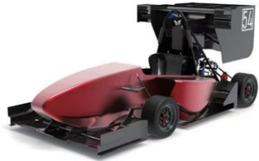
车辆采用钢管桁架式车架，车身及空套采用碳纤维复合材料，动力采用 Honda CBR600 发动机，在整备质量为 220KG 时最大输出功率 58.8KW (80HP) 条件下，整车功率比达到 267.3W/KG，电控方面设有牵引力控制系统和弹射起步系统。中国大学生方程式大赛创始车队之一。
