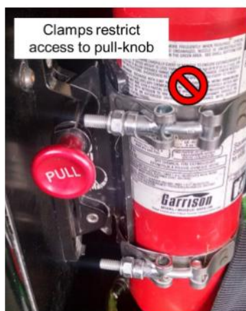
图B-61 灭火器夹头方向错误。
