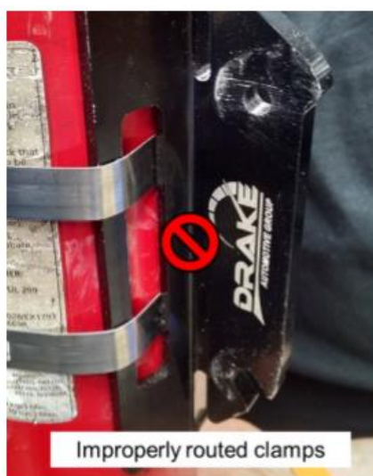
图B-62 软管卡箍错误固定示意图
