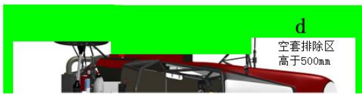
(6) 图四：在前轮轴中心线与后轮轴中心线之间的空气动力学装置（包括扩散器、侧翼）不能超出前后轮外表面在轮心高度处的连线
