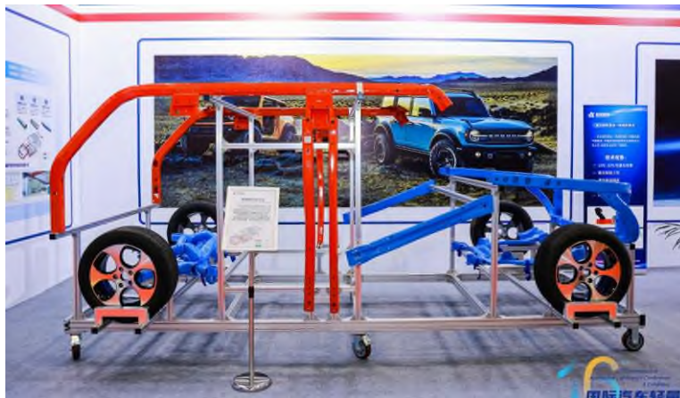
热气胀上横梁总成与隐藏式 2GPa 热气胀双 B 柱（红色）
