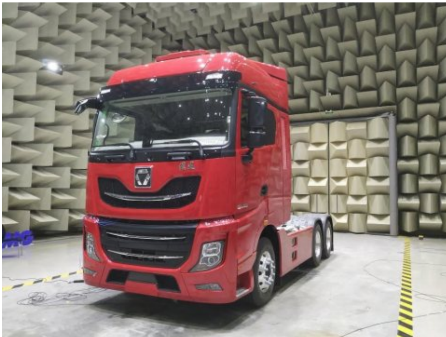
徐工漢風重卡 NVH 测试
