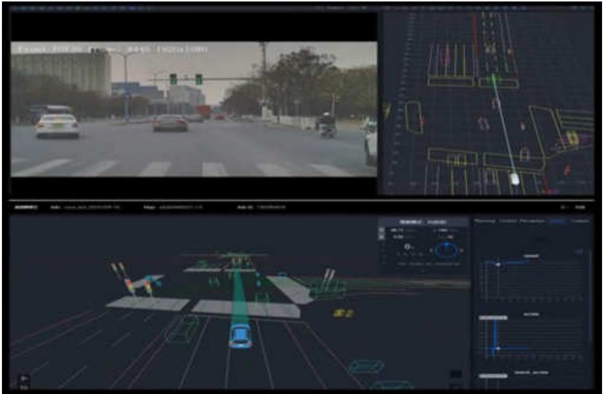
图 1. Log2world-基于真实车辆 badcase 场景数字孪生 通过仿真引擎，将实车数据转换成仿真场景，实现算法的闭环验证
