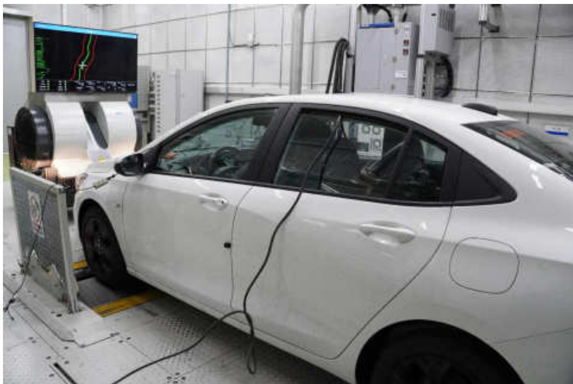
试验室开展 RDE 排放测试
