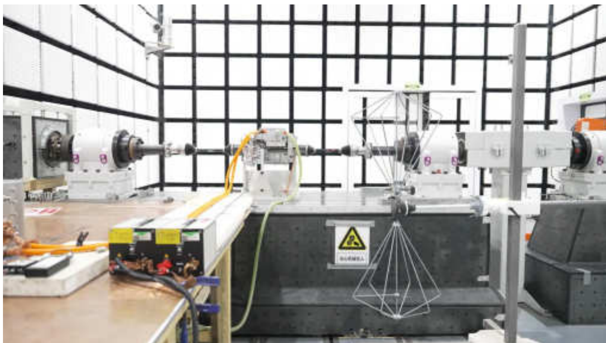
图 2 提出并搭建电磁辐射双轴加载测试方案并通过第三方机构计量检定
