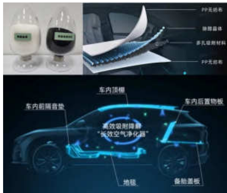
图 1 吸附降解材料、零部件复合结构示意图及整车布置示意图
